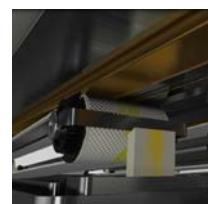
**Средства автоматического обслуживания** обеспечивают очистку печатающих головок при необходимости без вмешательства оператора
